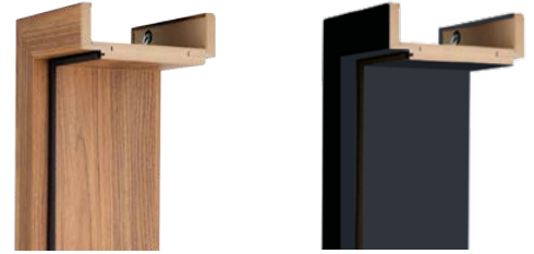
OŚCIEŻNICA REGULOWANA O ZAKRESIE 280-320 POSIADA KĄTOWNIK RUCHOMY Z PRZEDŁUŻONYM PIÓREM O 4 CM
