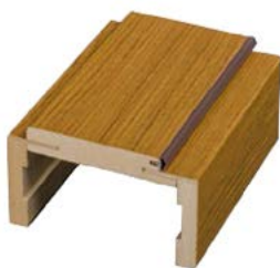
Przekrój pionowy drzwi przylgowych z OR
