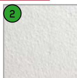
Wypełnienie spienionym polistyrenem EPS
