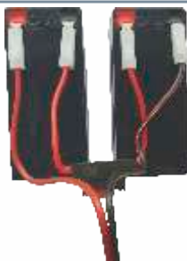
Akumulatory zasilania zewnętrznego DUMPER
